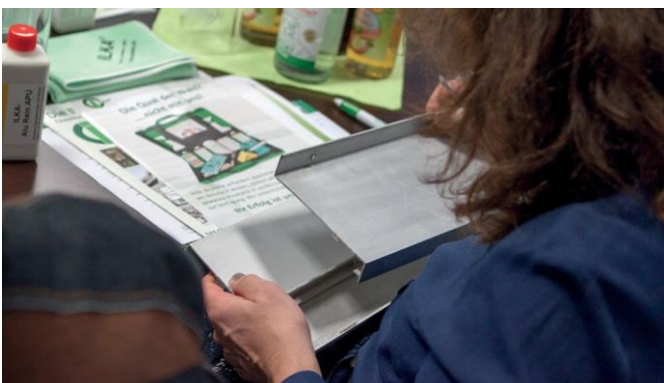
Kratzprobe zur Unterscheidung der Oberflächen: rechts reines Aluminium, links silbernes Eloxal.
